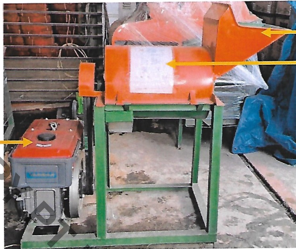
Gambar 3. Mesin penghancur ( crusher ) bahan baku pupuk organik tampak belakang
